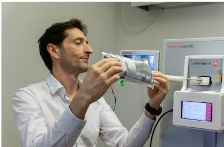
Pablo Sinues connecte un sac contenant un échantillon d'air à un spectromètre de masse pour l'analyser. © Université de Bâle, Christian Flierl. Si souffler dans le ballon est de rigueur lors de contrôles routiers, cet acte pourrait aussi se généraliser dans les hôpitaux, notamment en soins intensifs. Il s'agirait alors non pas de mesurer l'alcoolémie, mais de suivre en temps réel l'état de santé des patient-es et de contrôler le taux de certains médicaments.
